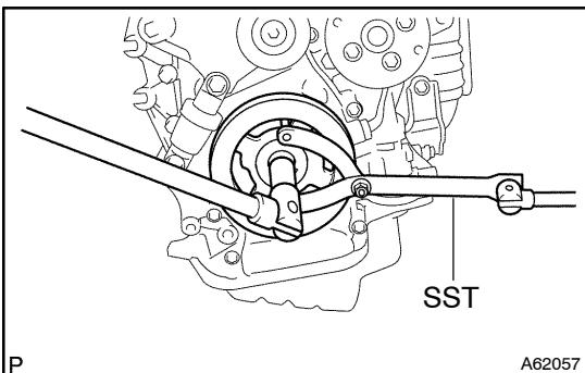
(d) Remove the crankshaft pulley (TMMK made).
