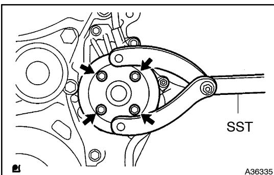
**85. INSTALL WATER PUMP PULLEY**
