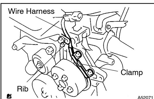
**86. INSTALL CRANK POSITION SENSOR**
