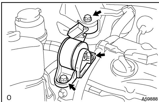
**57. INSTALL ENGINE MOVING CONTROL ROD W/BRACKET**
