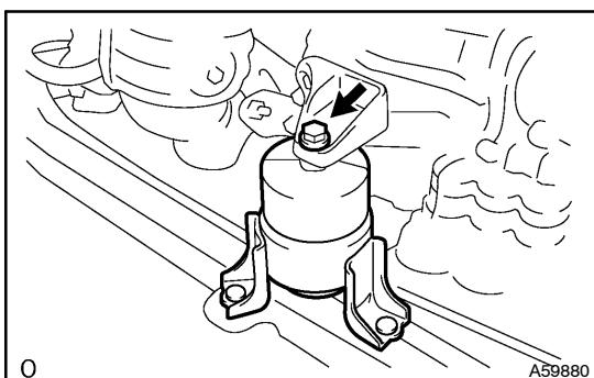
(d) Install the engine mounting insulator FR with the bolt.
